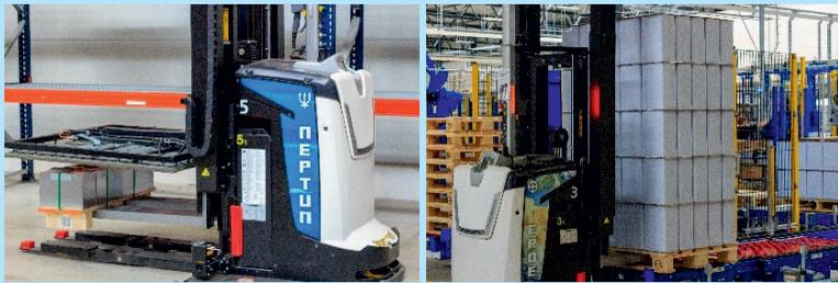
Abbildung 20: FTS bei der Bereitstellung von Rohmaterial und Fertigware
